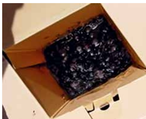
Figure 5.7 Fondeur solaire et vue des seringues fondues de la boîte de sécurité
