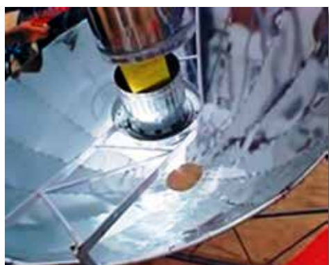
Figure 5.7 Fondeur solaire et vue des seringues fondues de la boîte de sécurité
